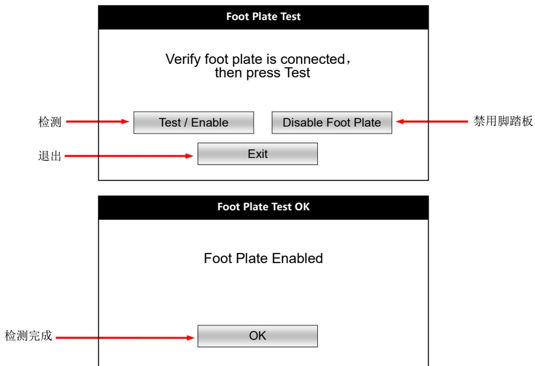
如果不需要使用脚踏板，例如只测试手通道，点击“Disable Foot Plate”，显示如下，点击“OK”后脚踏板被禁用。**注意：**一旦禁用脚踏板后，测试通道自动变更为“Wrist Only”只测手通道
