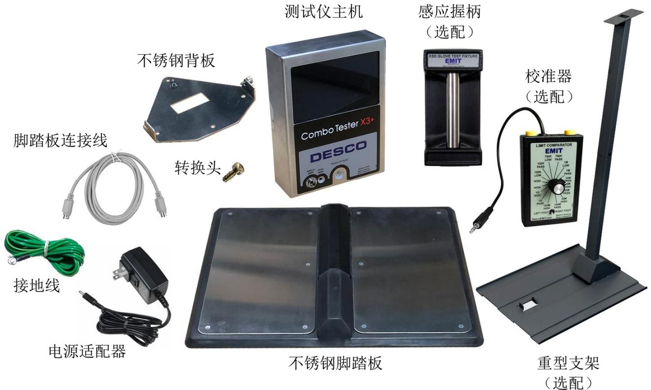
注意！转换头一旦插入单线手腕带插孔，无法取出，慎重使用该配件！
