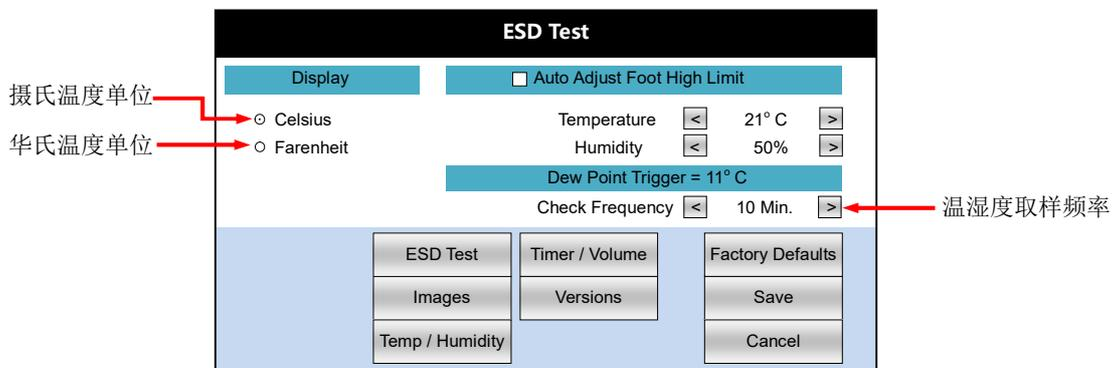
注：勾选“Auto Adjust Foot High Limit”后，会根据所设置的温度和湿度自动调整上限阈值，例如设置的上限阈值为 1G，当温度和湿度超过所设置的值，仪器会自动把上限阈值降到 100M。
