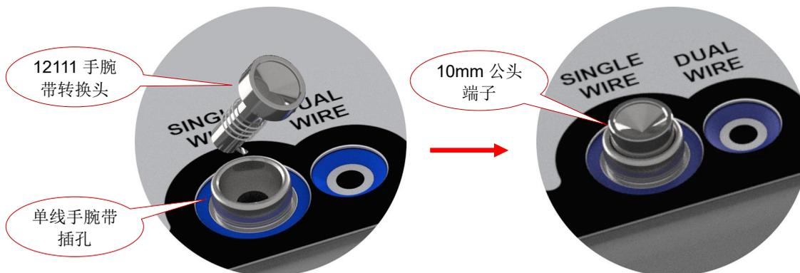
通常的单线手腕带的接地端是 4mm 灯笼插头，直接插在主机面板上的单线手腕带插孔即可。如果手腕带的接地端是 10mm 母扣端子，需要采用 12111 转换头。按上图所示把转换头插入主机面板上的单线手腕带插孔，可用于测试 10mm 母扣端子的手腕带。**注意！一旦插入转换头，就无法取出！**
