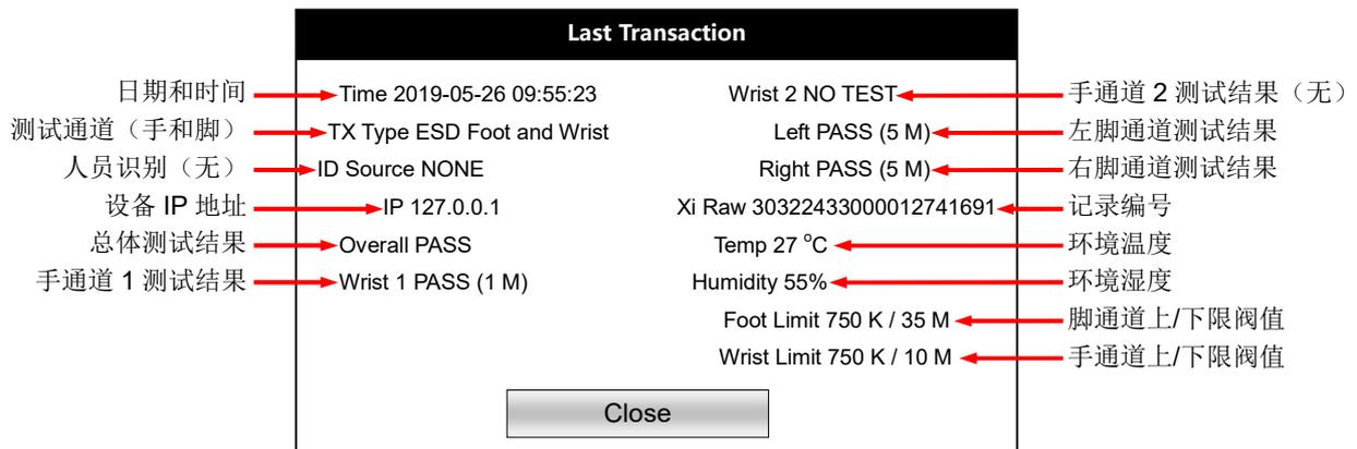
注：双线手腕带有 2 条接地线路，所以测试结果有“手通道 1”和“手通道 2”分别为 2 条接地线路的阻值；当测试单线手腕带时，只有“手通道 1”。
