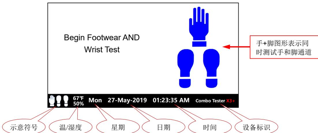
开机后，根据所设置的测试通道显示图形。出厂默认设置为同时测试手和脚通道，待机界面显示手和脚的图形，图形颜色表示以下各种状态：
