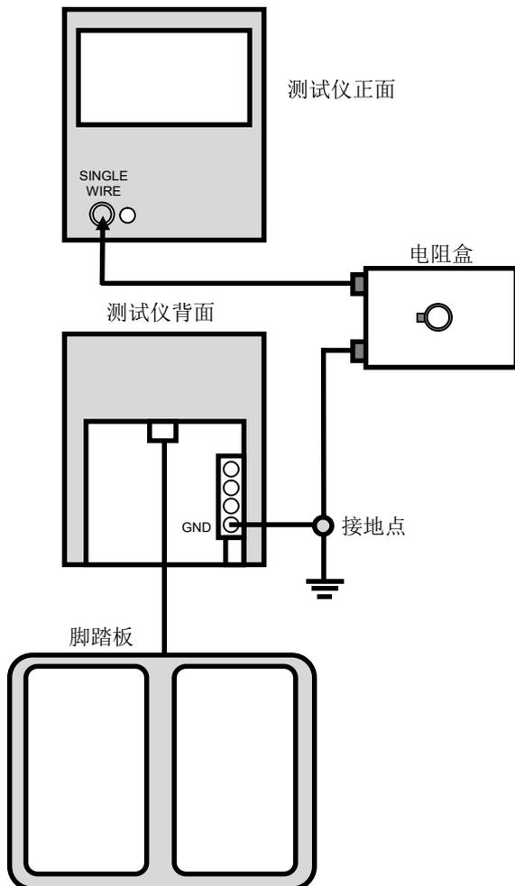
**校准手通道：按左边示意图接线**
